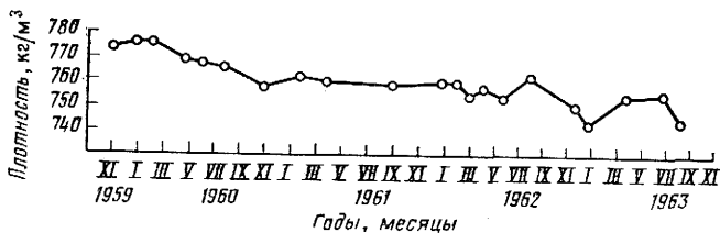
Рис. 8.6. Изменение плотности конденсата в процессе эксплуатации скв. 13 (ПК, верхняя часть) месторождения Зыря (А. С. Гаджи-Касумов, 1967 г.)
