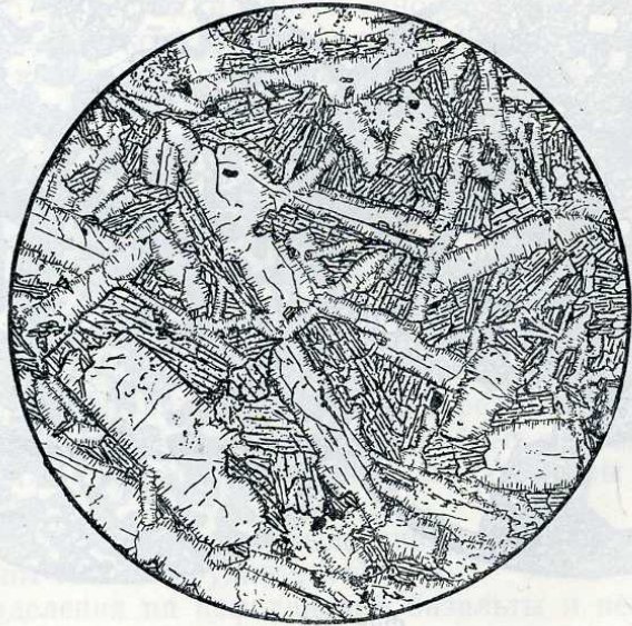
Фиг. 214. Мелилитовый базальт, Карагай, хребет Кетмень, Тянь-Шань. Мелилит и буровато-фиолетовый титан-авгит. Офитовая структура; d = 1,8 мм.
