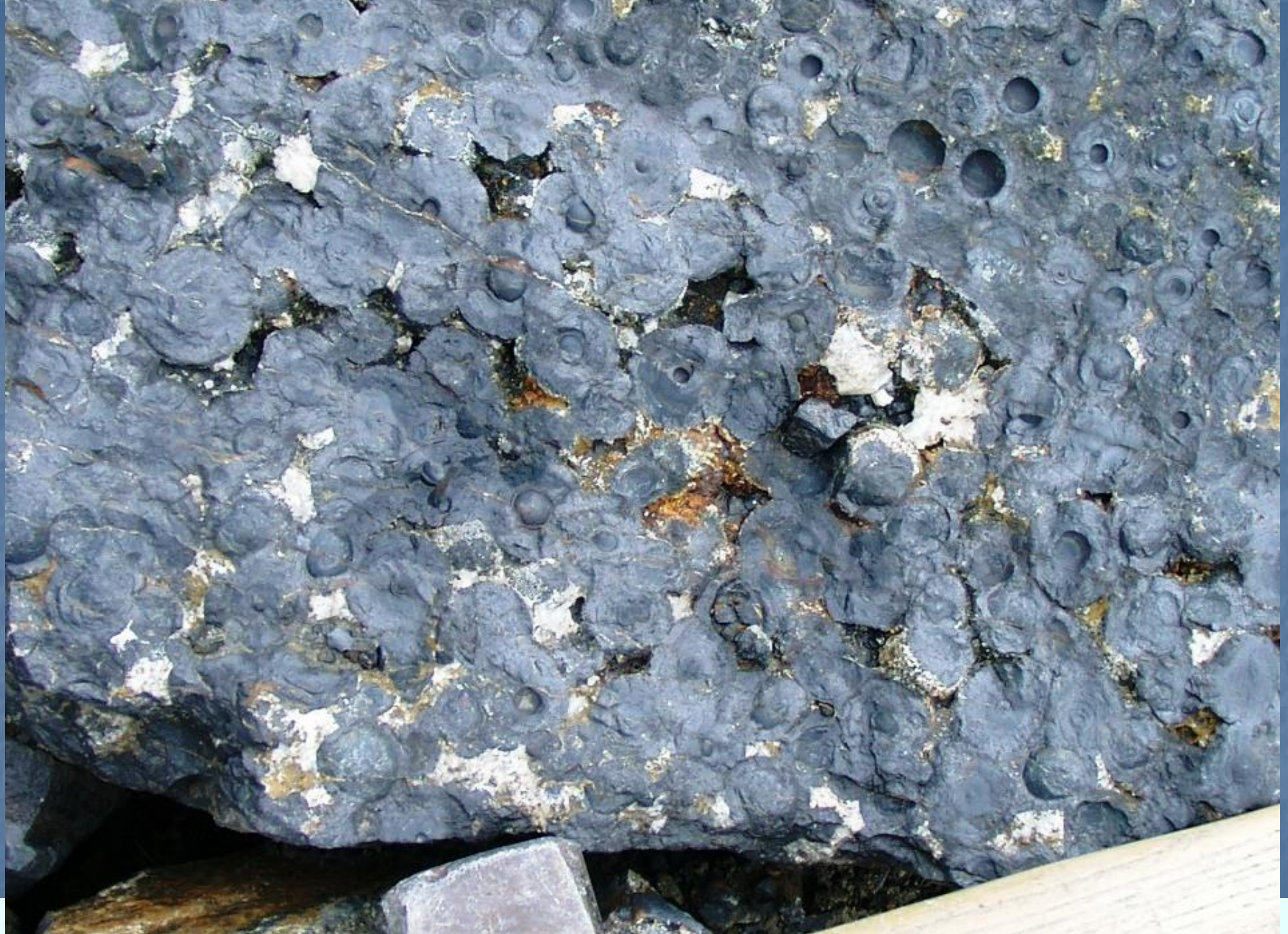
Рудногорское. Жильные сферолитовые магнетитовые руды с кальцитовым и галитовым цементом. Галитовый - выщелочен. Фото Э.М. Спиридонова
