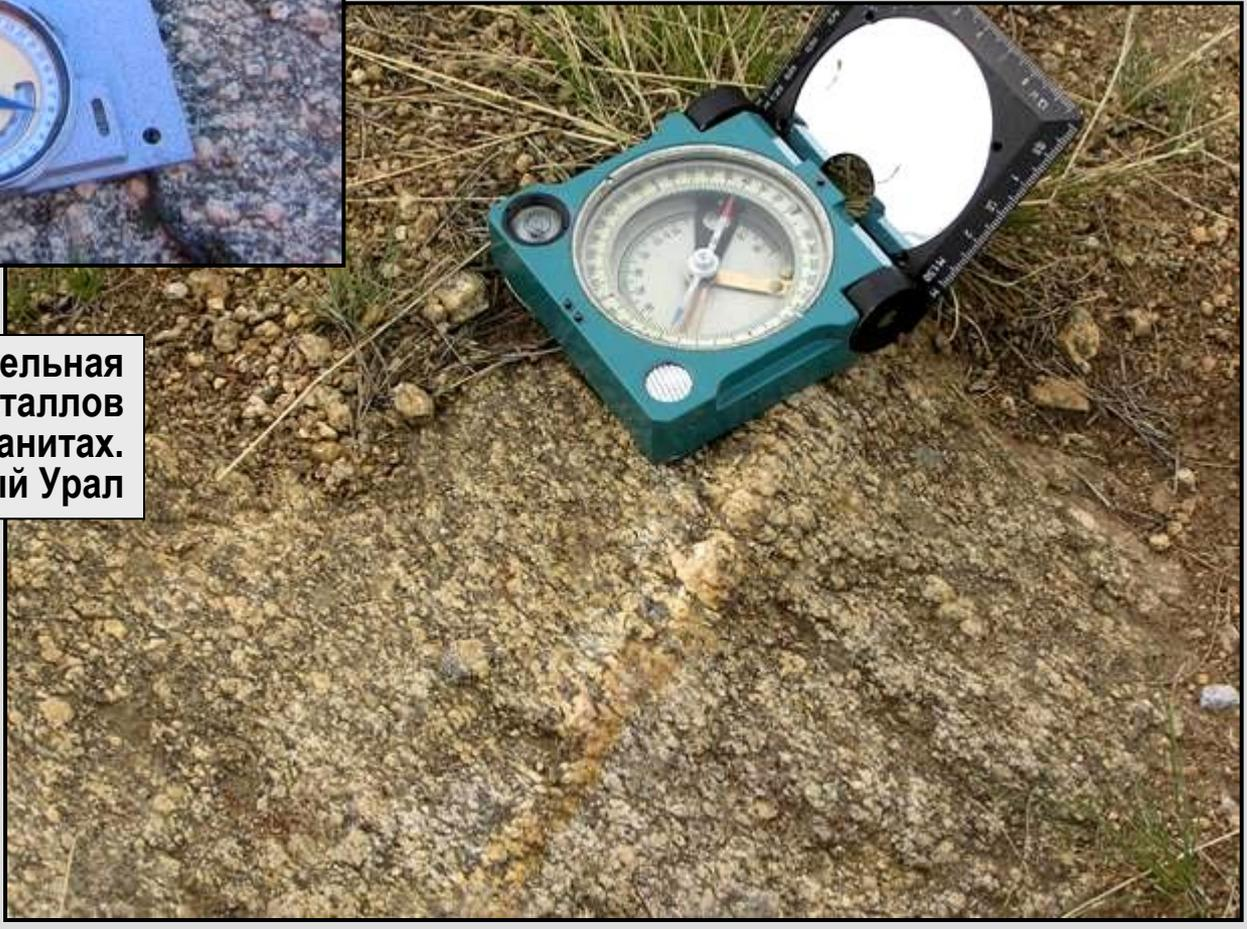
Вторичная плоско-параллельная ориентировка фенокристаллов калишпата в гранитах.
