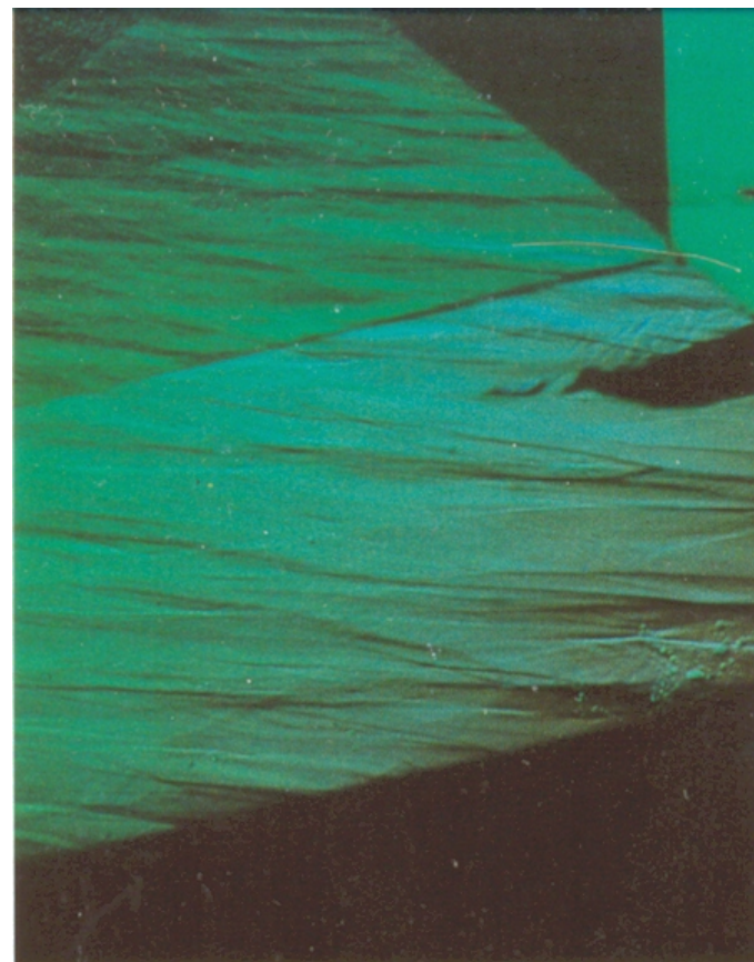
Параллельные или зигзагообразные внутренние структуры роста «ёлчатость» – в изумрудах российского производства, Новосибирск
