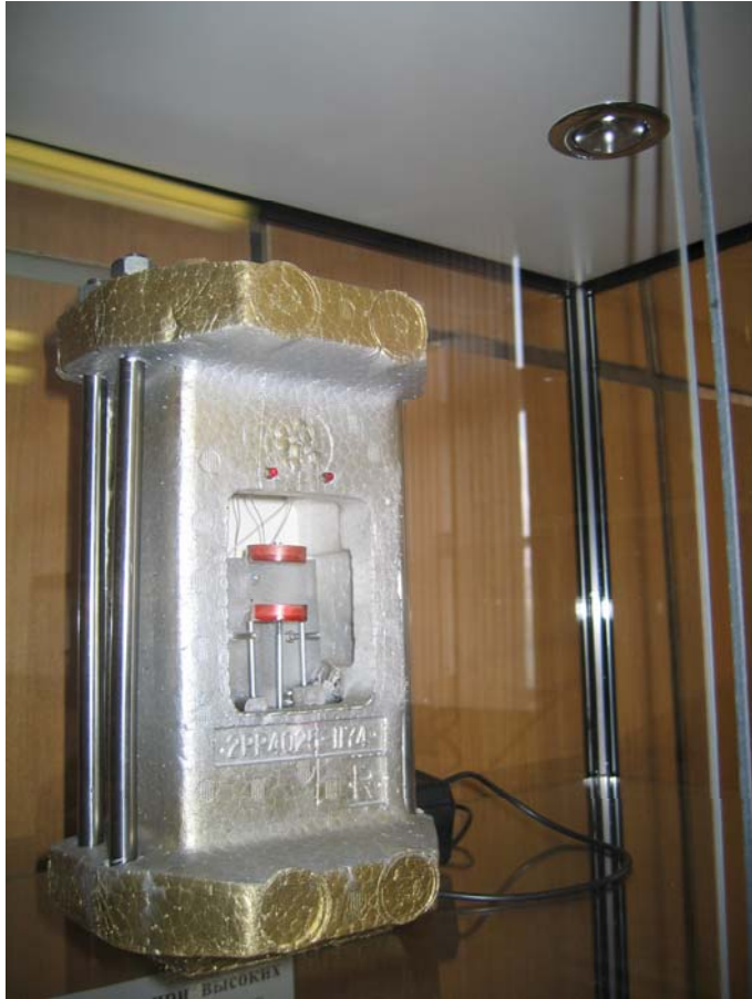
Камера для создания высоких давлений – для синтеза алмаза
