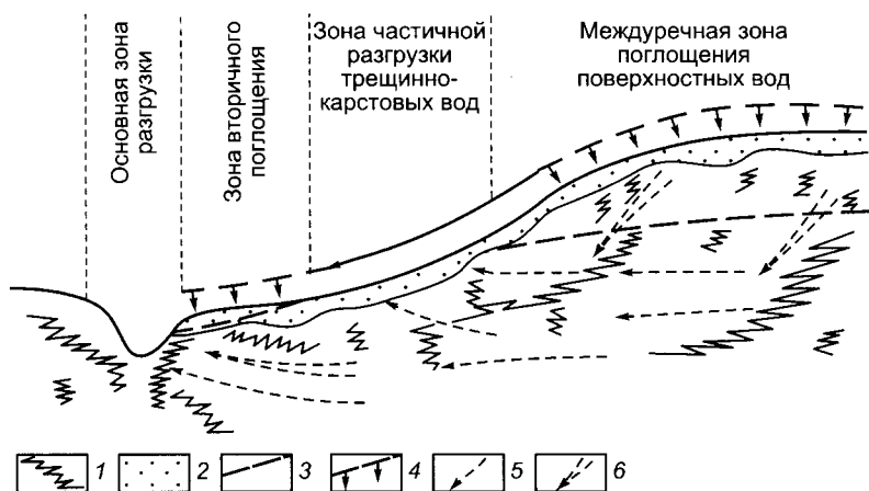
Рис. 9.6. Схема взаимодействия поверхностных и трещинно-карстовых вод (разрез по руслу притока основной дрены):
