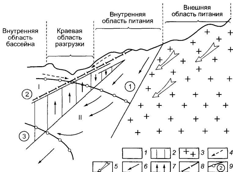
Рис. 10.4. Принципиальная схема формирования потоков подземных вод в краевой части артезианского бассейна платформенного типа:
