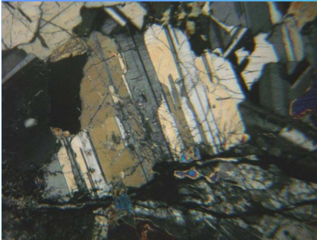
Плагиоклазам свойственны *двойники* — закономерные срастания кристаллов, имеющих общую кристаллографическую плоскость (плоскость срастания) и общее кристаллографическое направление, вокруг которого один кристалл повернут относительно другого на  $180^\circ$  (двойниковая ось). Плагиоклазы образуют либо простые двойники, состоящие из двух индивидов, либо полисинтетические двойники, которые состоят из нескольких индивидов
