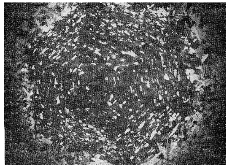
Рис. 42. Пойкилитовые включения альбита по зонам роста порфиробла кварца Ув. 10
