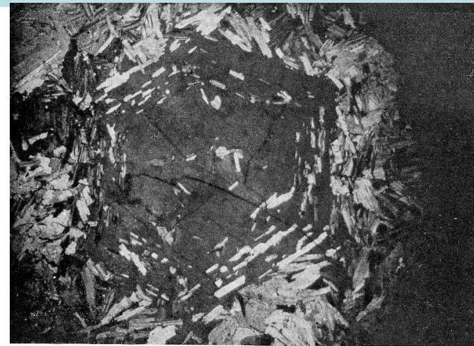
Рис. 60 Порфиробласты кварца с пойкилитовыми лейстами альбита, параллельными граням кристаллов кварца. Ув. 5
