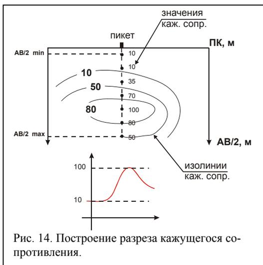
Рис. 14. Построение разреза кажущегося сопротивления.
