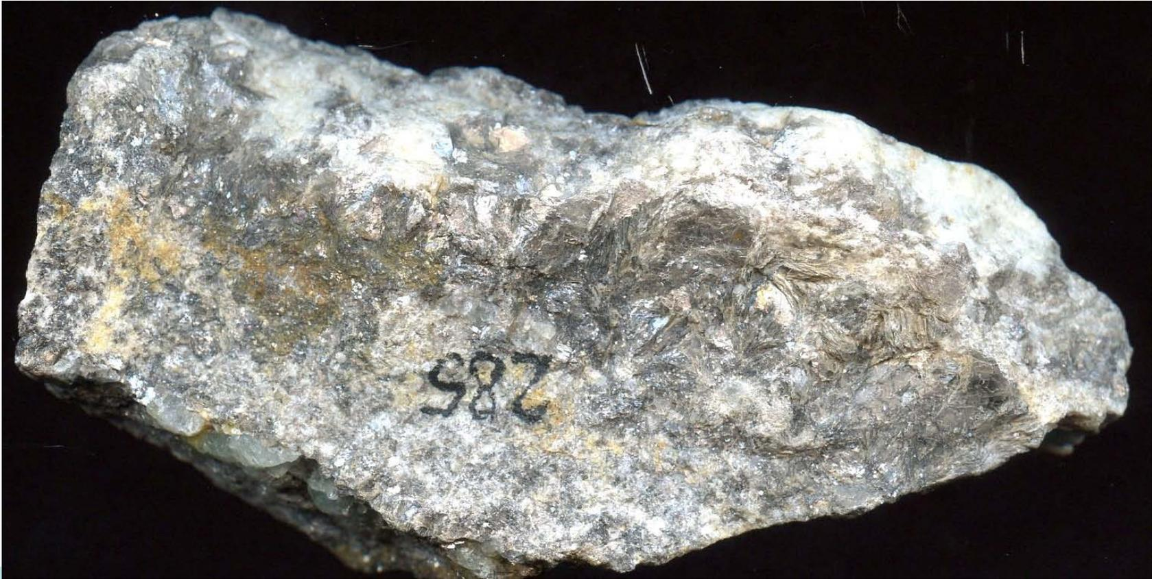
Скопление лепидолита в амазонитовых апогранитах на контакте с изменёнными роговиками.
