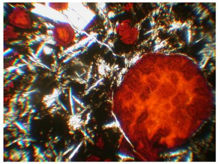
Структура афировая. На краю шлифа отмечен единственный вкрапленник плагиоклаза, Основная масса сложного строения. Она состоит из базиса, близкого к интерсертальной структуре, сложенной каркасом микролейст плагиоклаза, промежутки между которыми заняты мелкими зернышками клинопироксена и измененным стеклом. Пузырьки заполнены гетит-селадонитовым агрегатом
