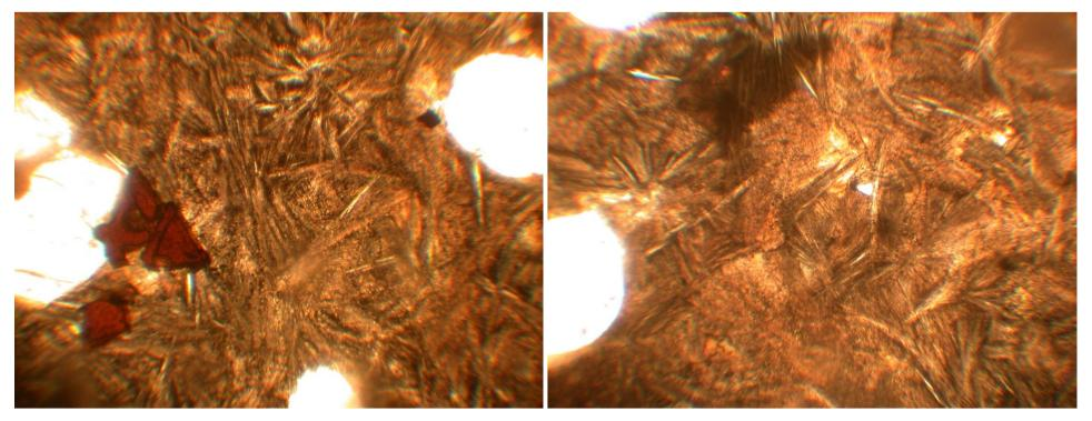
Структура порфировая. Вкрапленники идиоморфного оливина и пироксена, относительно крупные зерна хромшпинелида, просвечивающие бурым. Основная масса состоит из радиальных агрегатов длиннопризматических кристаллов плагиоклаза с расщеплёнными концами, часто образующими радиально-лучистые агрегаты и криптокристаллического агрегата, который не изотропен, но разглядеть, что за минералы — не получается. Текстура слабопористая. Много округлых газовых пузырей.
