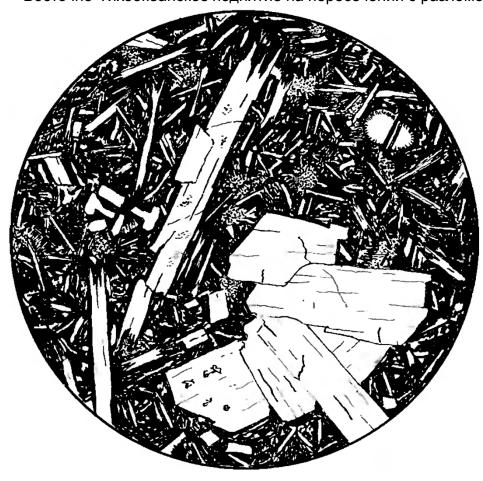
1016-9/2. Базальт толеитовый. d = 3,1 мм. Структура гломеропорфировая, основная масса гиалопилитовая. Плагиоклаз преобладает и встречается в виде крупных зерен, образующих иногда гломеровые сростки, а также в виде лейст и микролитов в основной массе. Плагиоклазы погружены в стекловатый базис с мельчайшим агрегатом и перистыми срастаниями слабо индивидуализированного клинопироксена. Вне поля зрения встречаются редкие разрозненные фенокристы клинопироксена, резко подчиненные плагиоклазу.
