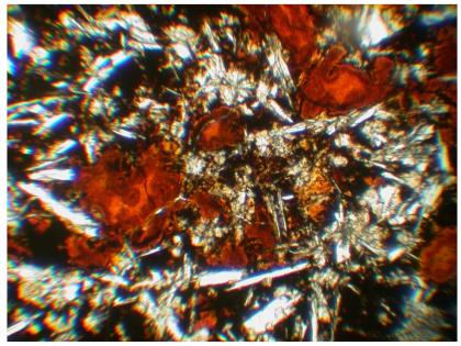
В данном шлифе микролиты плагиоклаза имеют тонкие, часто расщепленные окончания. Ранний оливин замещен иддингситовым агрегатом, в то время как мелкий оливин основной массы свежий. Пузырей в породе мало, они имеют идеально круглую форму и полностью заполнены селадонит-гетитовым агрегатом. Стекло в основной массе так же замещено вторичными минералами, среди которых хорошо различимы пластинчатые выделения рудного (ильменит?). Дополнения - Плечов, 2009
