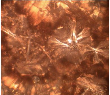
Около 50-ти процентов шлифа занимают округлые выделения, внутренняя часть которых состоит из расщеплённых кристаллов плагиоклаза. Эти кристаллы окружены криптокристаллическим агрегатом с муаровым погасанием, вариолями. Вариоли погружены в бурую тёмнокоричневую массу стекла.
